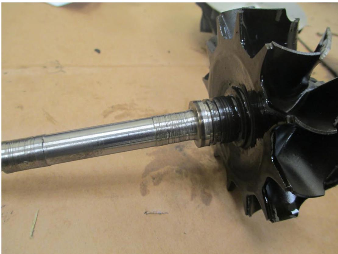
*Рисунок А.2 – Абразивный износ поверхности ротора ТКР*
