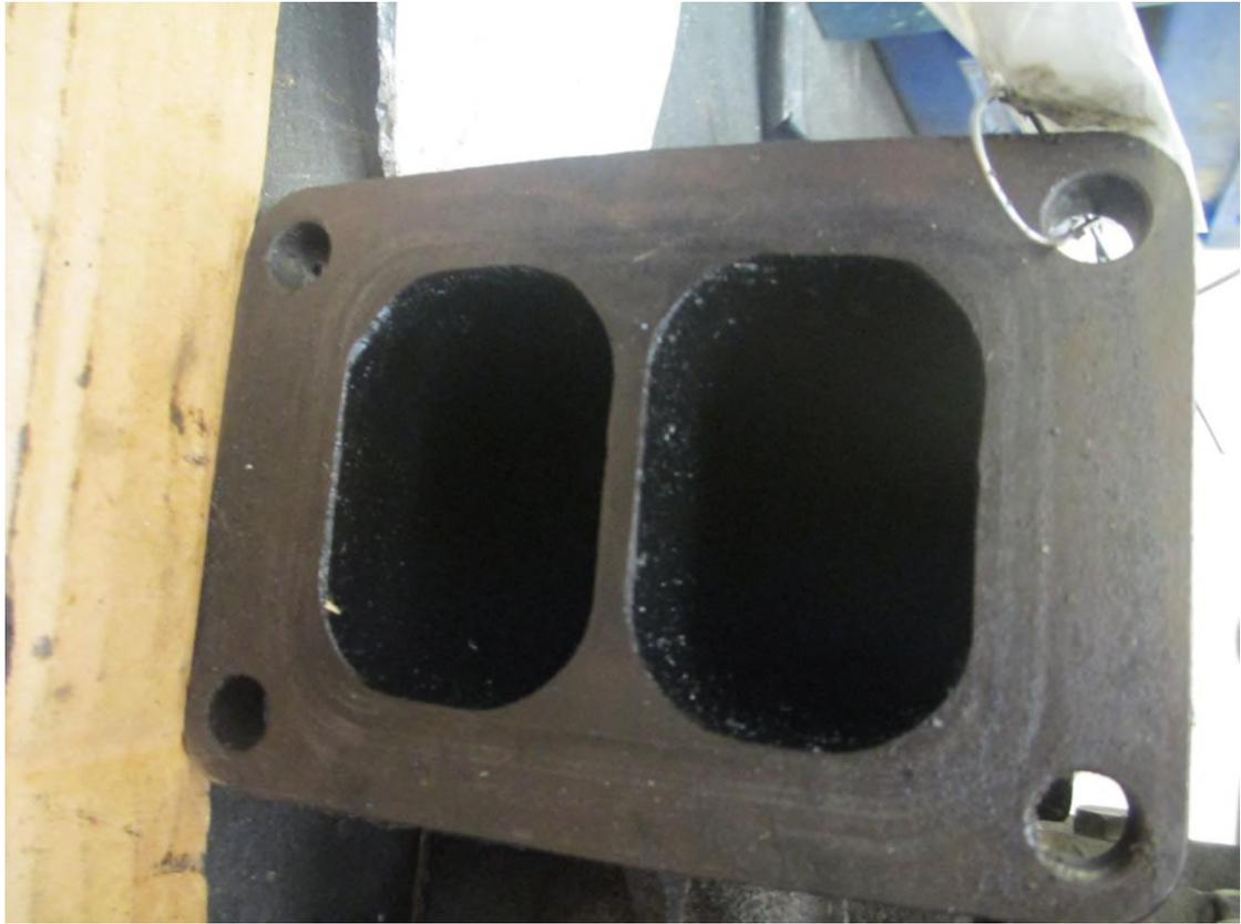
*Рисунок А.23 – Масло на входе в турбину*
