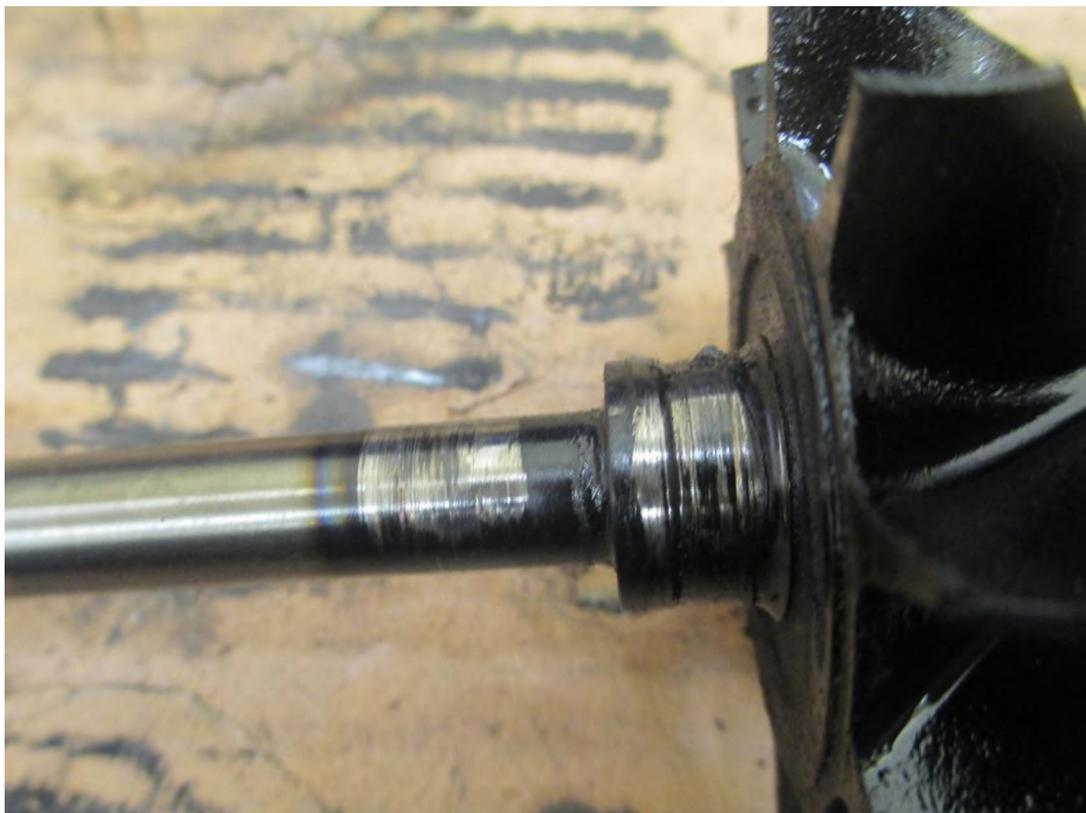
*Рисунок А.9 – Задир ротора при перегреве*
