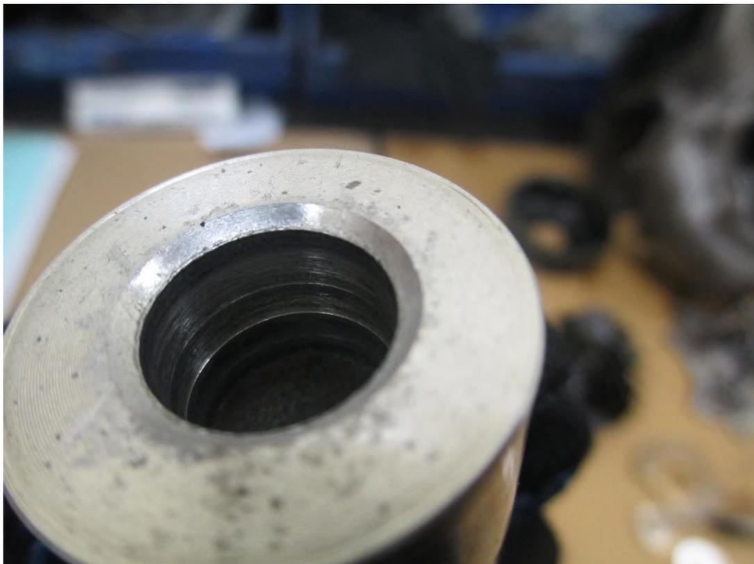
*Рисунок А.12 – Состояние втулки радиального подшипника при задире*
