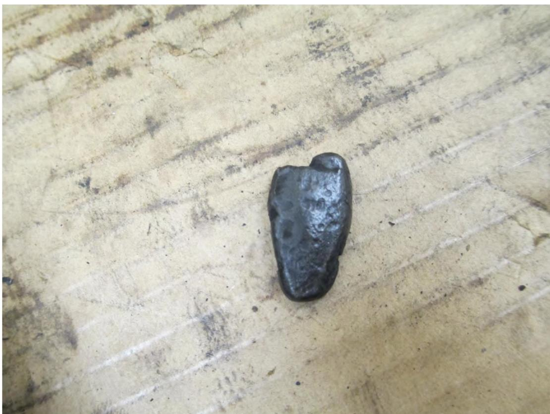
*Рисунок А.18 – Посторонний предмет в компрессоре ТКР*
