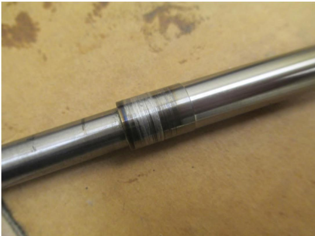
*Рисунок А.10 – Задир ротора при масляном голодании*
