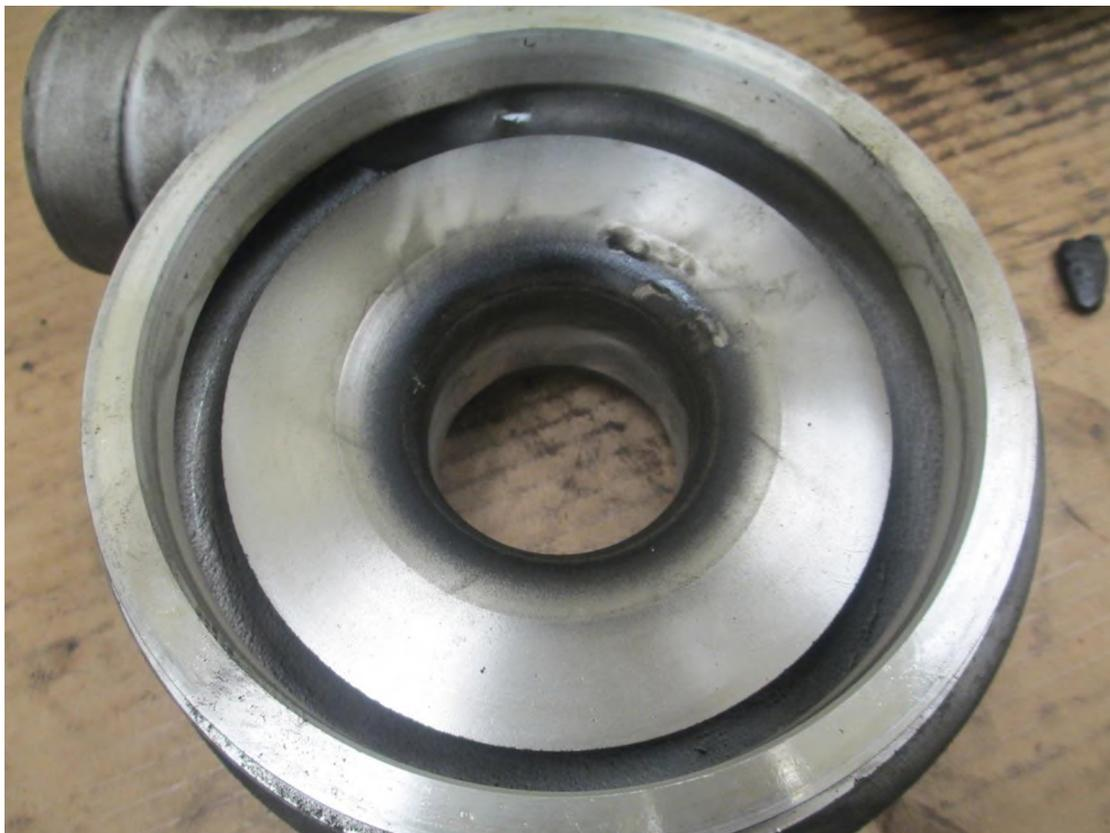
*Рисунок А.17 – Посторонний предмет в компрессоре ТКР*
