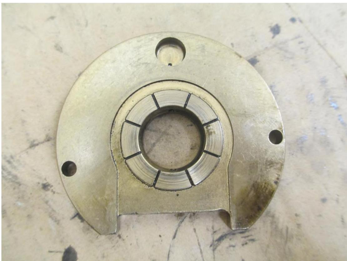
*Рисунок А.4 – Абразивный износ упорного подшипника ТКР*
