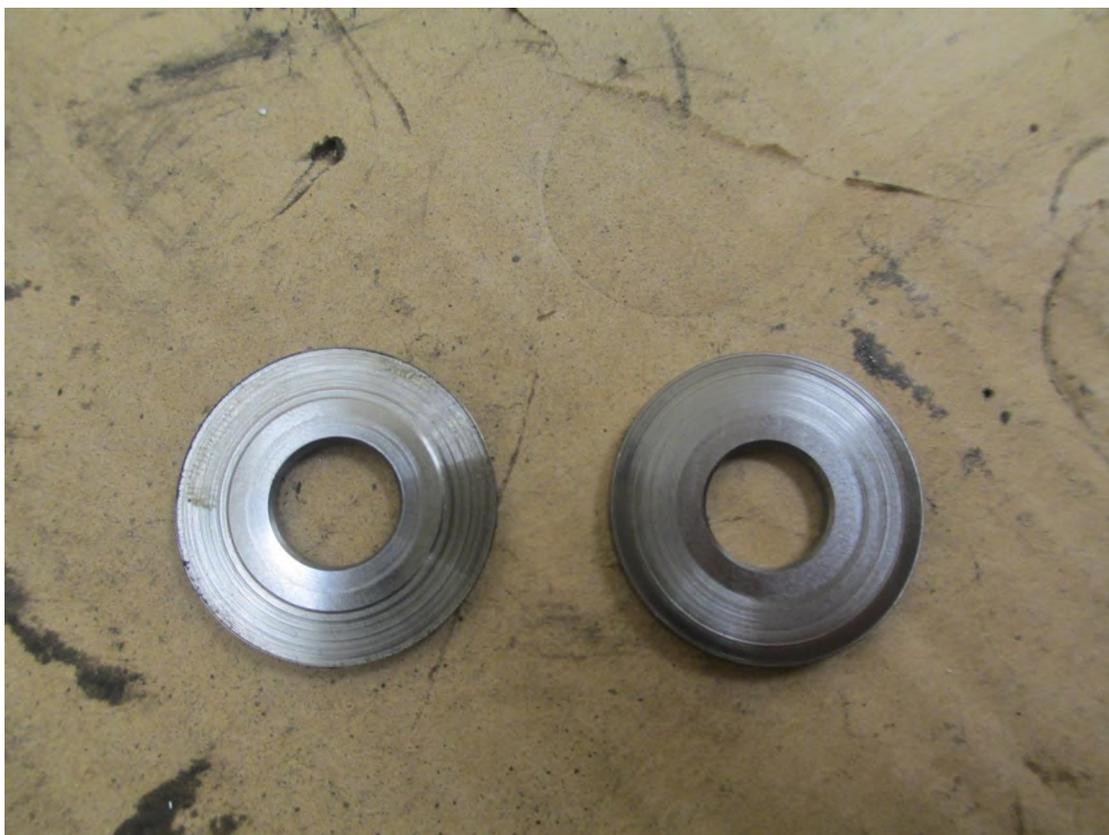
*Рисунок А.5 – Абразивный износ упорных шайб ТКР*
